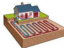
La puissance prélevée est de 10 à 15 W/m de longueur de capteur, soit 25 à 37 W/m<sup>2</sup> de champ de capteur.
